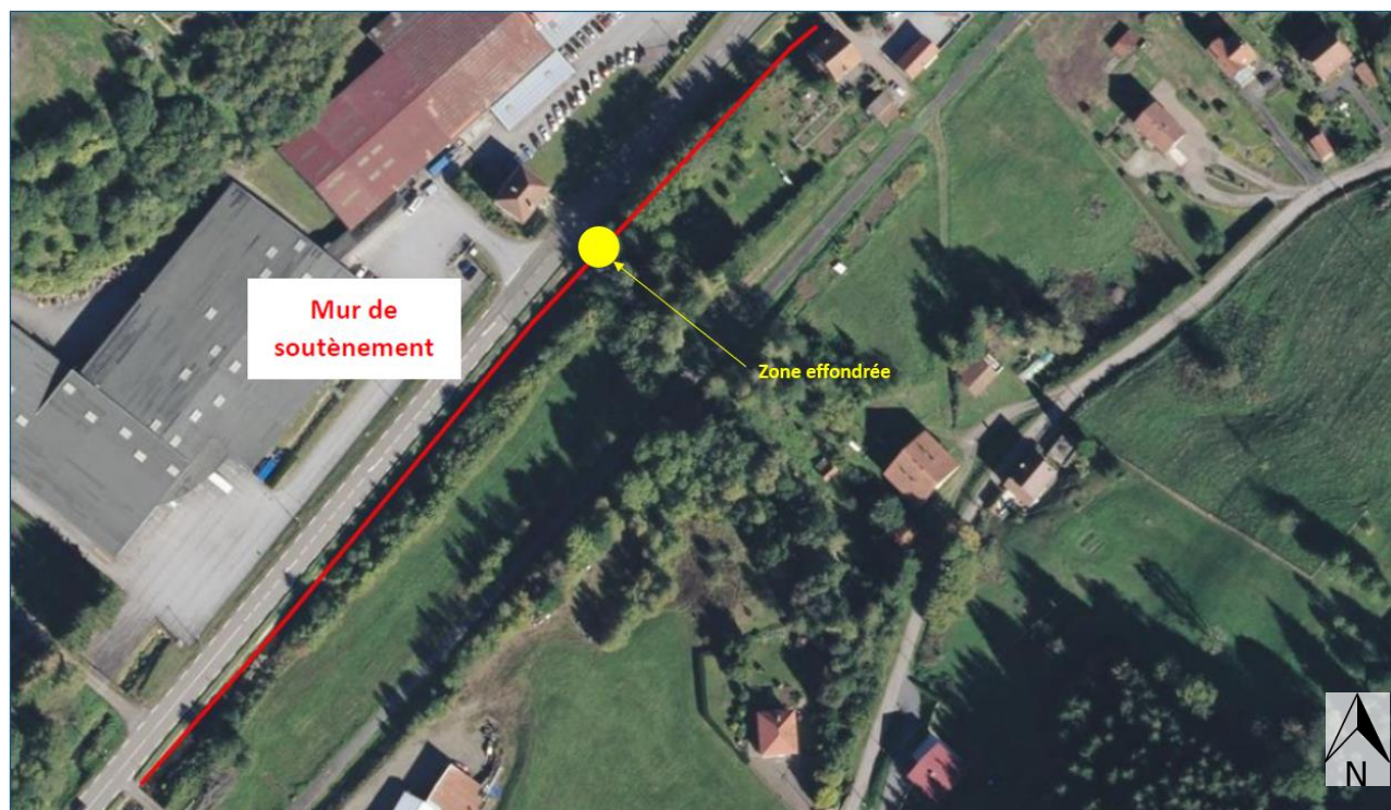
Figure 2: Schéma de repérage de la zone effondrée du mur
