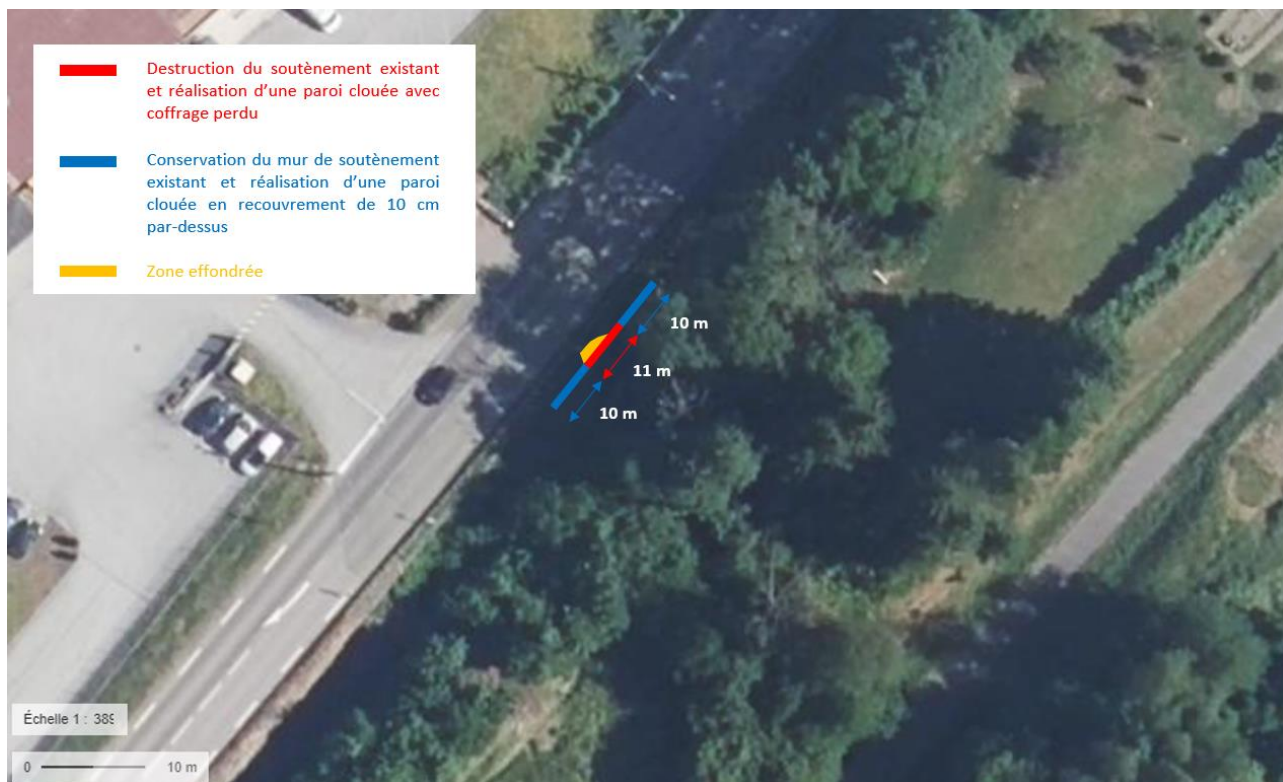
Figure 5 : Projet de reprise du mur de Bussang à la suite de son effondrement le 13/12/2024
